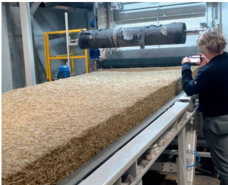
Vom Moor zur Bauplatte: Testproduktion von Dämmstoffen aus Paludibiomasse im industriellen Maßstab.
